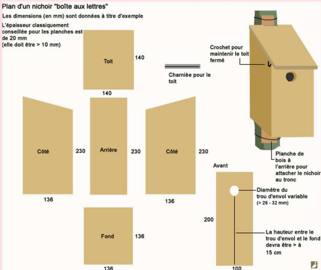
Le diamètre du trou de l'entrée doit être de 28mm pour la mésange bleue et de 32mm pour la mésange charbonnière. Il doit être exposé sud, sud-est et à 4-5m de hauteur. Il est conseillé d'installer le nichoir à l'automne, cloué sur l'arbre ou avec des gaines de caoutchouc. Il sera ainsi repéré plus rapidement et pourra aussi servir de refuge hivernal pour les oiseaux sédentaires. Les nichoirs doivent être installés à 10-15m les uns des autres.
